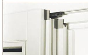
Darüber hinaus gibt es weitere Profile im Bereich Flügelüberschlag, z. B. für 15 oder 18 mm Falzhöhe. Vergleichsmessungen haben gezeigt, dass die Höhe der Überschlagdichtungen bei Schallschutzfenstern praktisch keine Rolle spielt.
